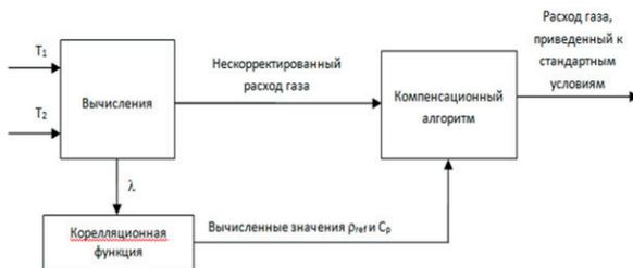
**Рис. 6 Структура алгоритма газовой компенсации**
